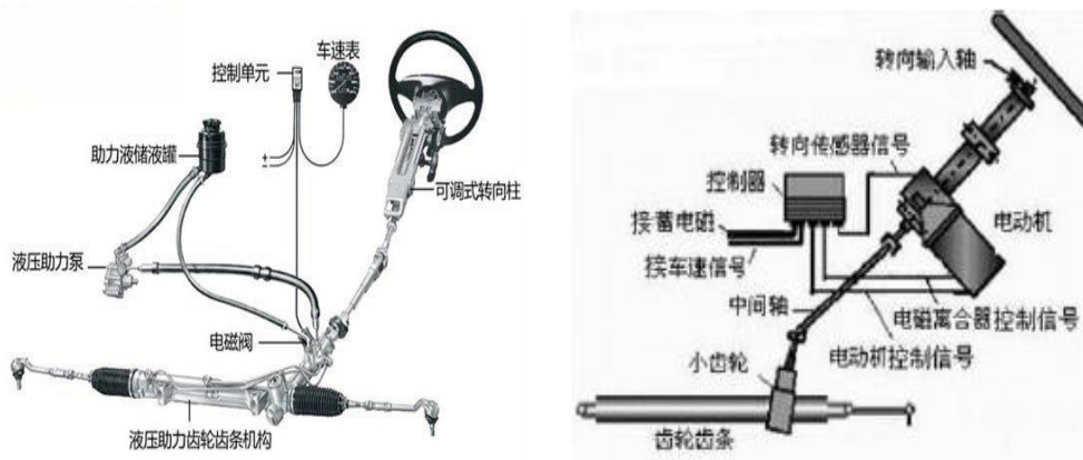
图：HPS（左）与 EPS（右）装置示意图比较
