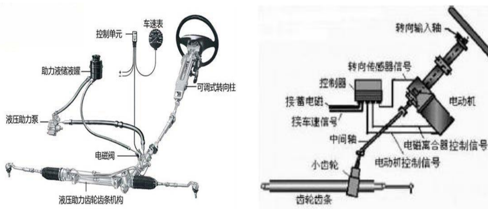
图：HPS（左）与 EPS（右）装置示意图比较
